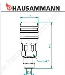
Ganzmetall Sicherheits-Luftkupplung STREAMLINE
